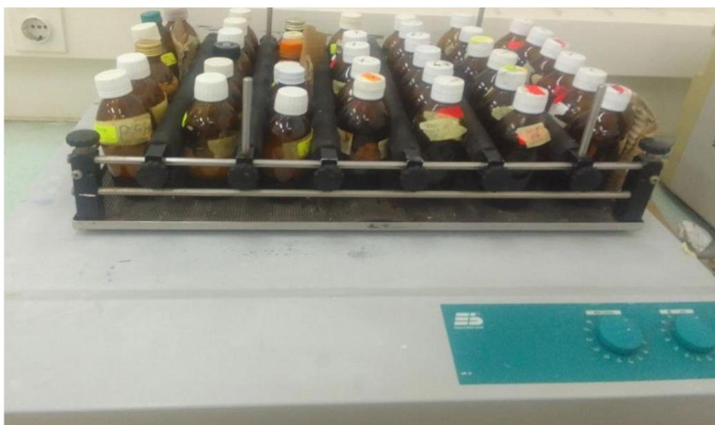
**Figure II.5.** Photographie numérique montrant le test de adsorption en mode batch
