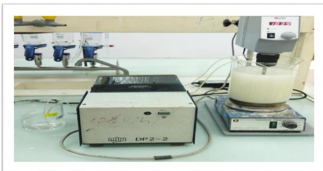
**Figure II.1** : Photographie montrant la préparation de l'argile pontée montm-Al<sub>13</sub>-CTAB.
