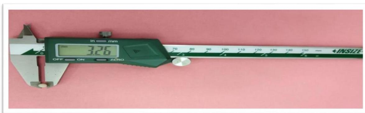
Figure II.4: Mesure de diamètre par pied à coulisse .
