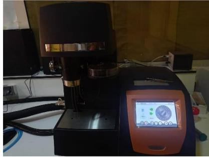
**Figure III. 10** : Appareil d'analyse thermogravimétrique type TGA 5500.
