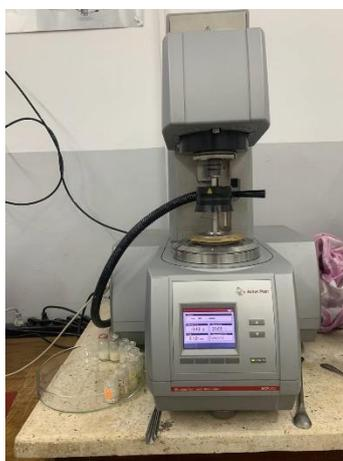
**Figure III. 11:** Rhéomètre type Anton paar.
