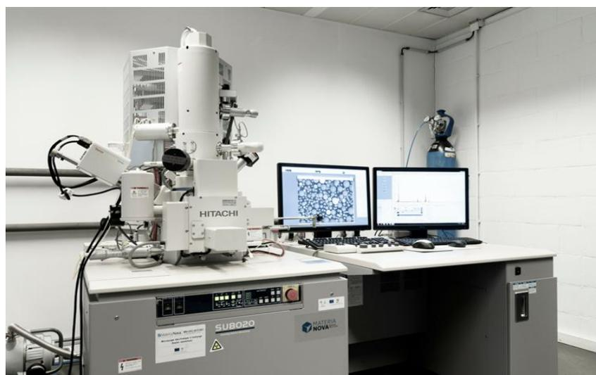
**Figure II.4: Appareil de l'analyse MEB/EDS**
