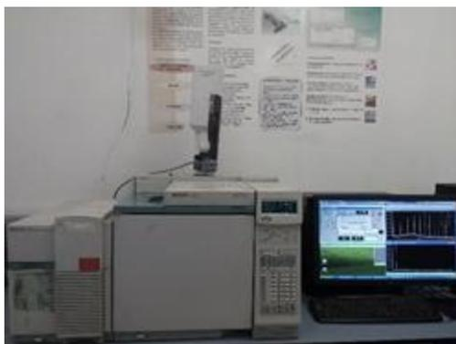
**Figure III.15: Hewlett Packard Agilent 6890 plus**
