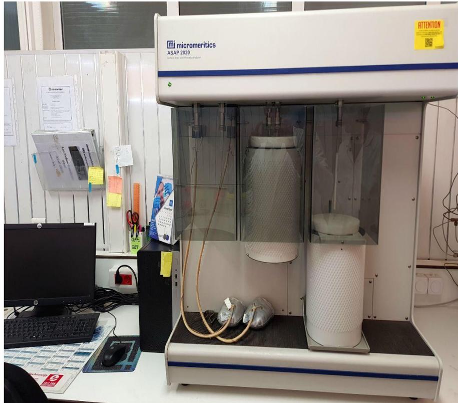
**Figure II.6: Appareil de la mesure de surface spécifique par BET**
