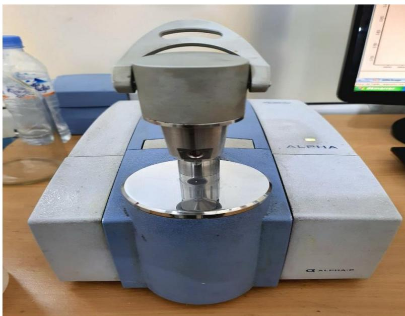
**Figure II.5: Appareil de l'analyse ATR**
