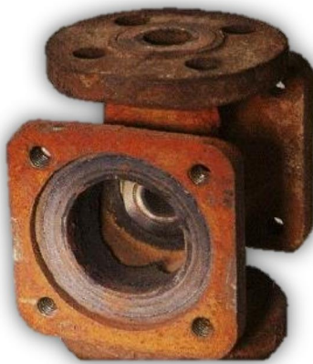
Figure1.1. Corrosion générale (rouille) d'une pièce en acier
