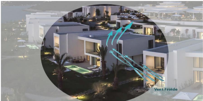
Figure 54 : Schéma montrant les facades fermée face aux vents froids. Source : Voyage-prive.com, Traitée par : Auteurs, 2025.
