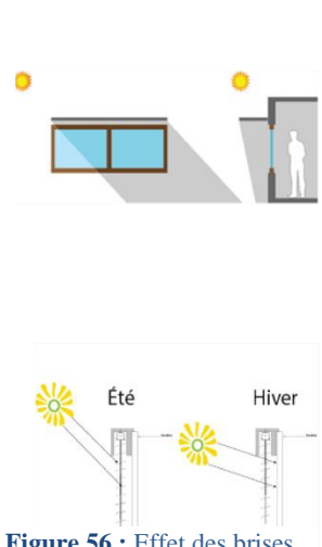
Figure 56 : Effet des brises solaires, source: energieplus
