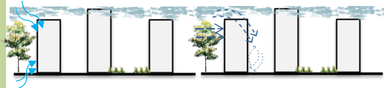
Figure 142 Coupe schématique qui représente les effets de coins et l'effet de barre traité par l'auteur
