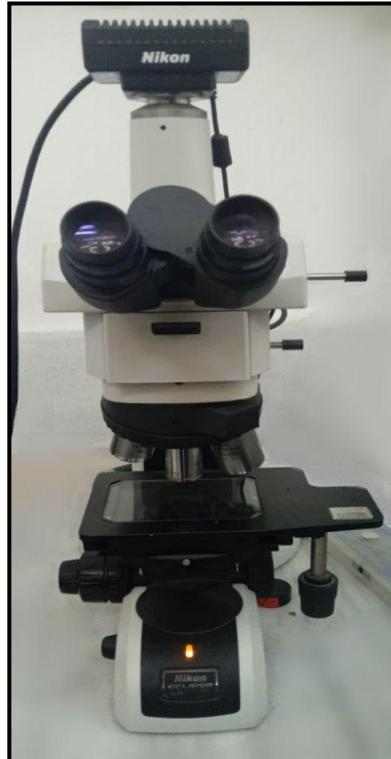
**Figure II.8** : Microscope optique.
