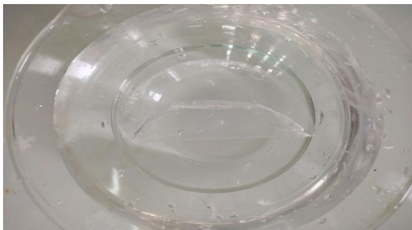
Figure 15: Décollage de film PET /PVC dans un bain de l'eau distillée.
