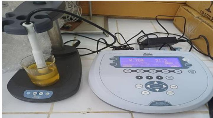
**Figure 09 : conductimètre (photo personnelle, 2025)**
