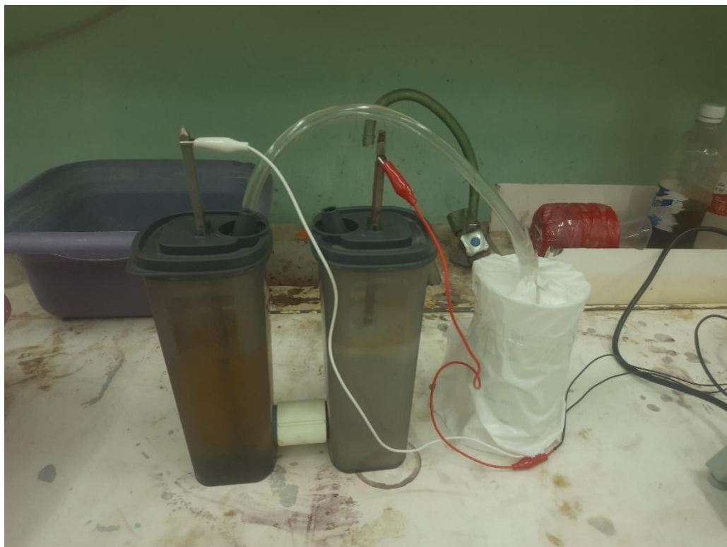
Figure Annexes B 4 : cellule de production de l'eau de javel
