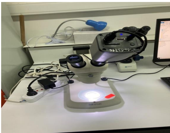
Figure II-7 : Observation microscopique des MPs sous la loupe binoculaire
