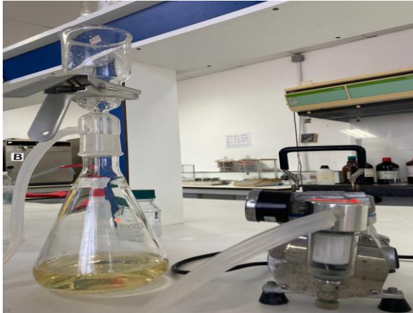
Filtration des digestats
