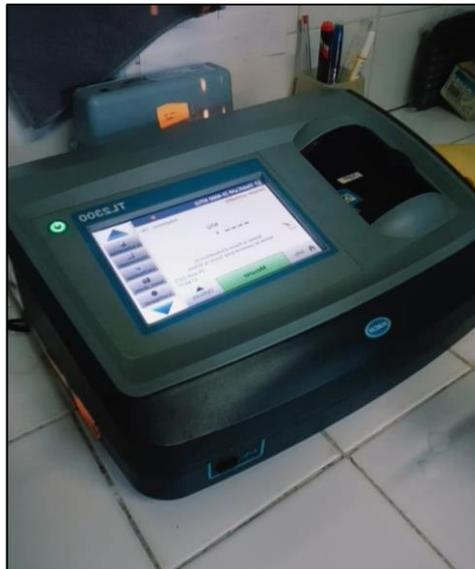
**Photo 3** : Appareille pour la mesure de la turbidité de l'eau.
