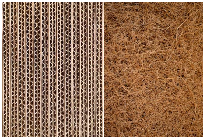
Figure I 1: Panneaux d'isolation thermique bio-composite à base de carton et de fibres de palmier dattier [28].
