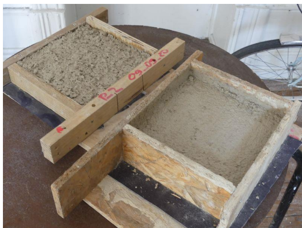
Figure I 2: Panneau isolant à partir de bois et de chaux [29].
