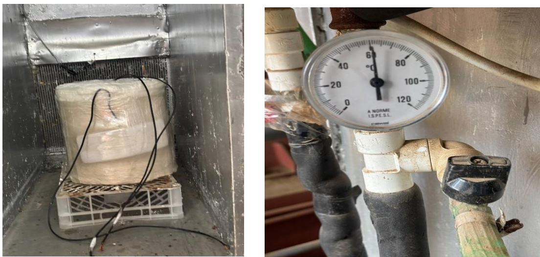
Figure II 9: Traitement thermique des échantillons à 60 °C.
