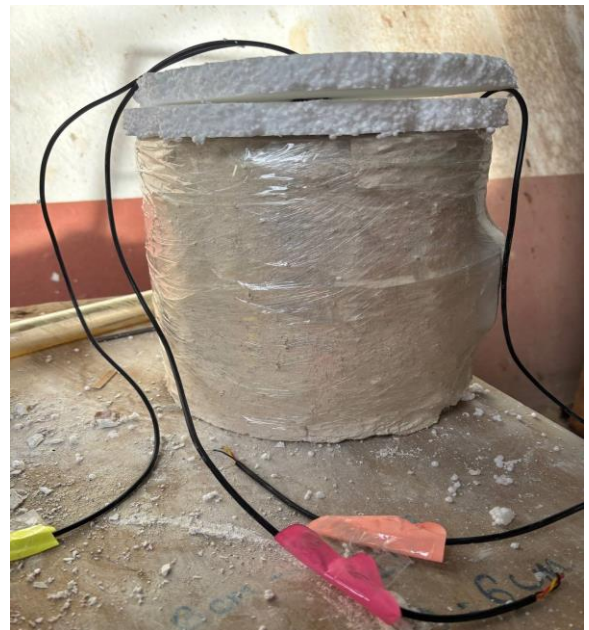
Figure II 8: Photographies montrant l'installation des sondes.
