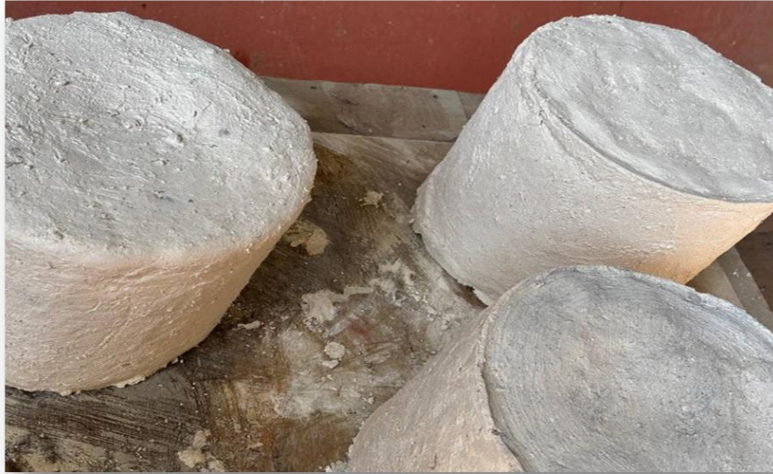
Figure II 7: Photographie montrant le lissage des échantillons 48 h à température ambiante.
