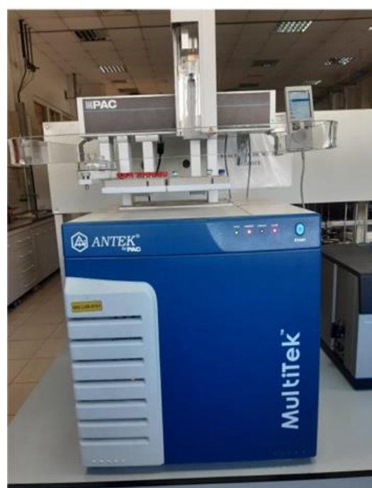
Figure 4 : Analyseur de soufre Antek MultiTek
