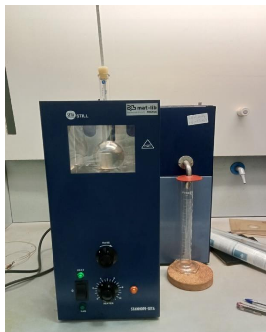
Figure 2 : Distillateur manuel SETA
