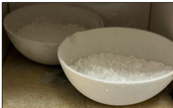
Figure III.5 : Placement des poudres de carbonate de calcium dans des creusets avant le traitement thermique au four à moufle.
