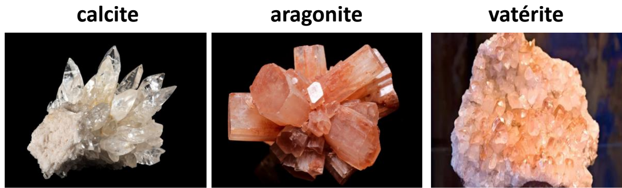
Figure II.2 : les 3 Formes cristalline de \text{CaCO}_3 . [15]
