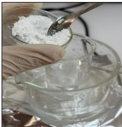
Figure III.6 : Ajout progressif de la chaux vive à l'eau chaude sous agitation et mesure du pH.
