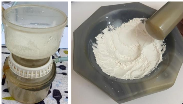
Figure III.3 : Filtration et broyage de la poudre après le traitement chimique.
