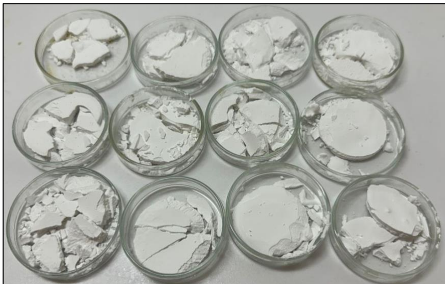
Figure III.8 : Poudre de carbonate de calcium (PCC) obtenue après séchage à 105^\circ\text{C} .
