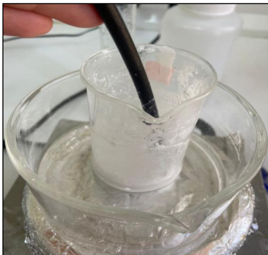
Figure III.7 : Injection contrôlée de \text{CO}_2 dans la suspension et suivi du pH pour optimiser la précipitation du carbonate de calcium.
