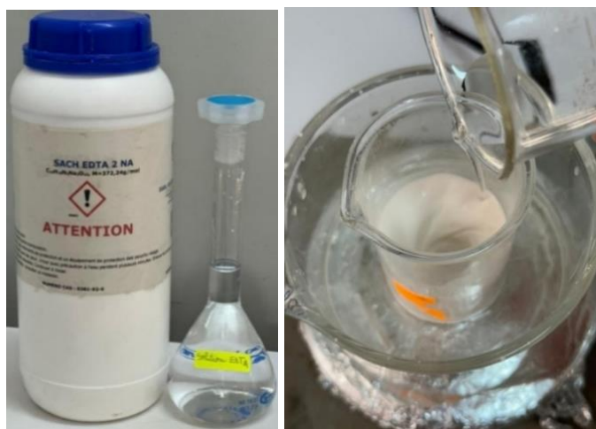
Figure III.4 : Schéma illustrant la préparation de la suspension de carbonate de calcium et l'ajout progressif de la solution d'EDTA à différentes concentrations sous agitation continue.
