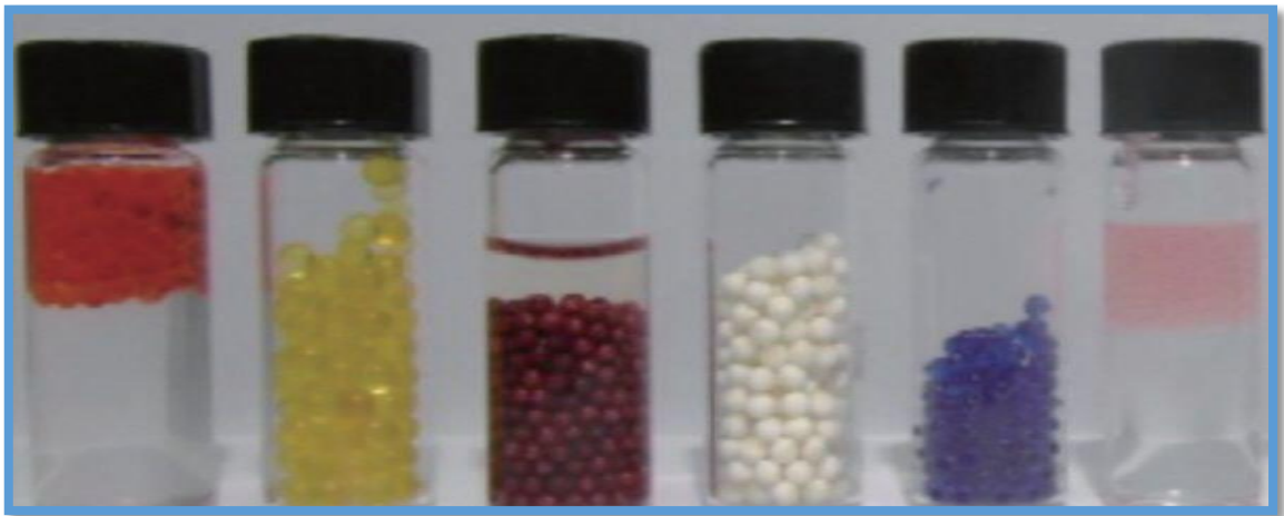
Figure I.3 : Billes gélifiées de différentes natures et couleurs élaborées par différentes technologies d'encapsulation.
