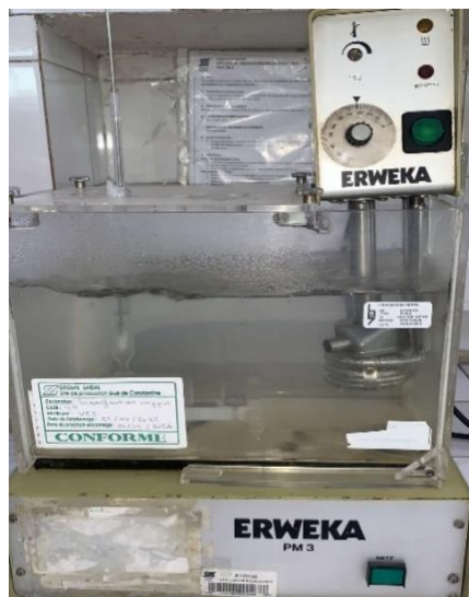
Figure V.10 : Dispositif utilisé pour la détermination du temps de ramollissement des suppositoires
