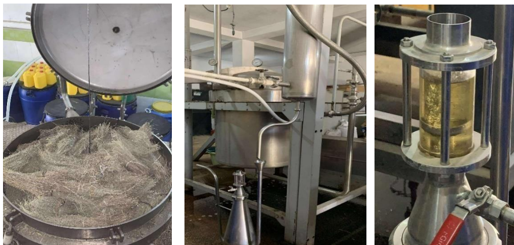
Figure V.3 : Extraction de l'HE d'armoise blanche par entrainement à la vapeur à l'échelle industrielle
