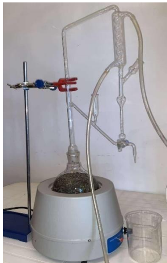
Figure V.2 : Extraction de l'HE d'armoise blanche par hydrodistillation
