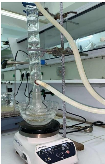
Figure V.4 : Montage à reflux utilisé pour la détermination de l'indice de saponification.
