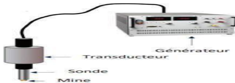
Figure III.3 : Illustration de la sonde à ultrasons [104].
