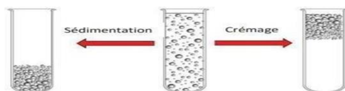
Figure III.10: Illustration des phénomènes de séparation gravitationnelle [111].
