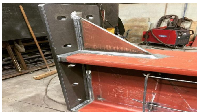
Figure VII.1 : Exemples des assemblages soudés.
