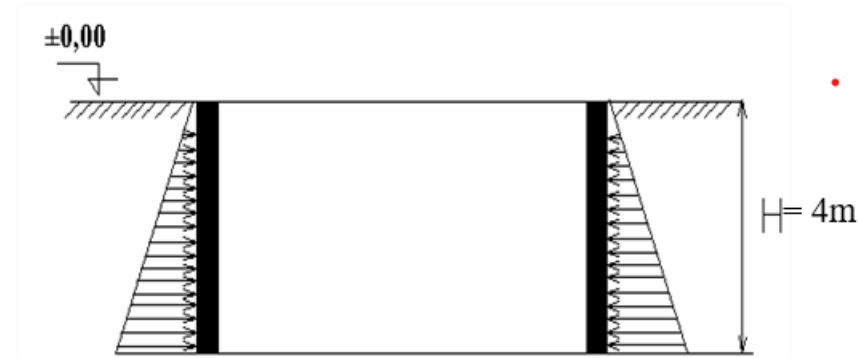
Figure VII. 10: Poussées des terres.
