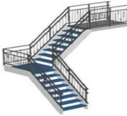
Figure I. 10: Escalier en charpente métallique.
