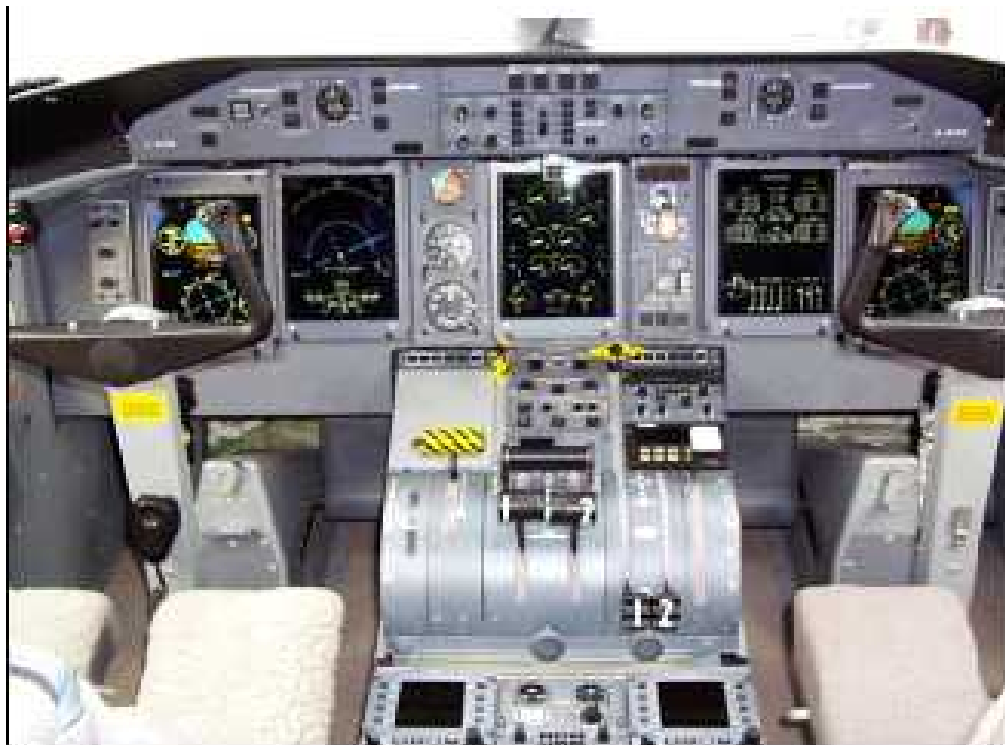
Fig.III.6 Aménagement général du Cockpit
