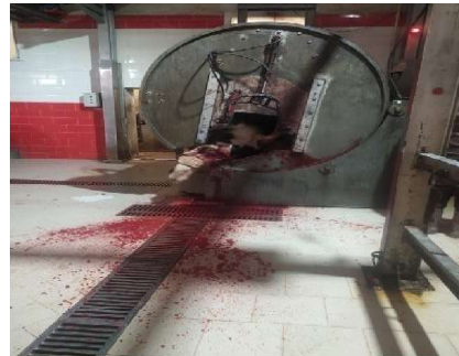
Figure 11: Le box d'étourdissement rotatif (Photo personnelle). L'abattoir d'Ouled Mendil, à Alger, s'appuie largement sur des équipements mécaniques pour optimiser le processus d'abattage.
