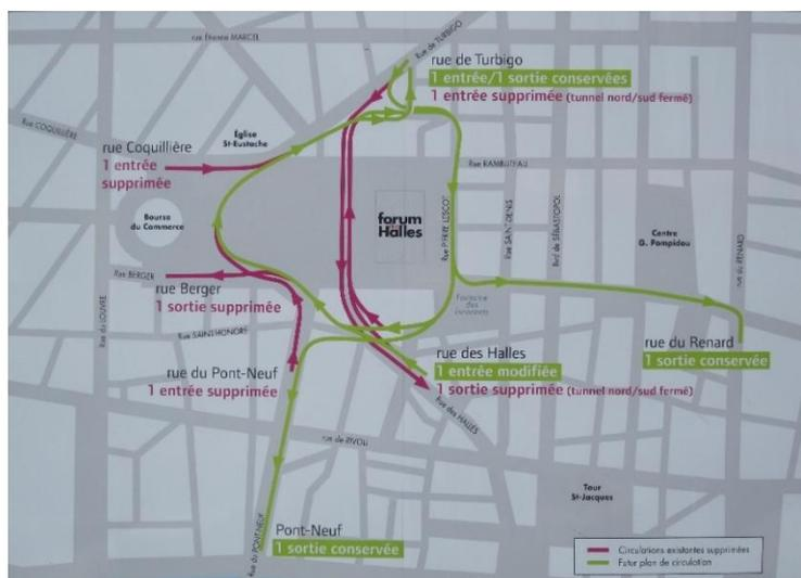
**Figure 12 :** Plan de restructuration de la voirie souterraine des Halles.
