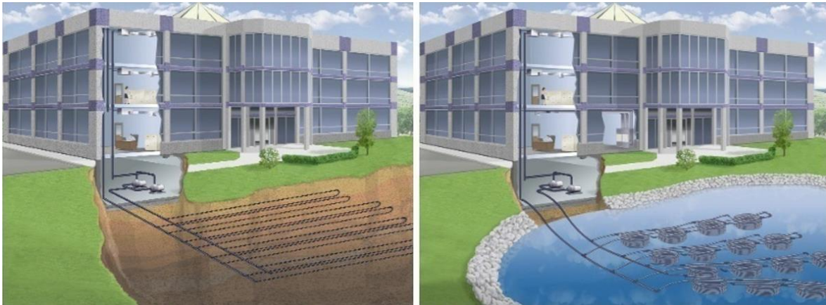
Figure N° 29 : pompes à chaleur géothermiques
