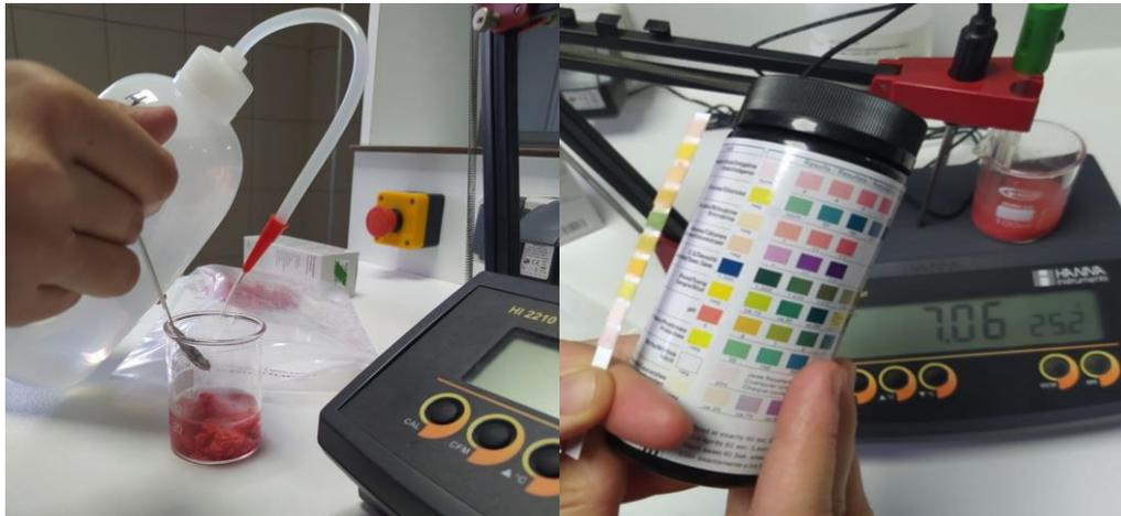
**Figure 11:** mesurage du pH à l'aide d'un pH-Mètre et Bandelette pH (photographie originale)
