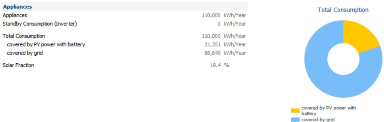
Figure 138 : : Pourcentage d'utilisation de l'électricité générée par les PV par rapport à la consommation totale. Source : PV\*SOL
