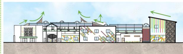
Figure 3.127 : variation de hauteur et forme de toiture
