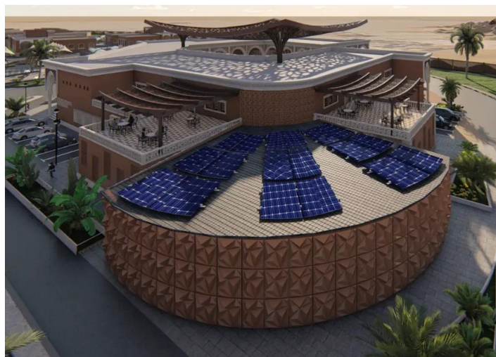
Figure 124: disposition des PV sur le toit d'entité de centre culturel
