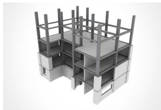
*Figure 229 : system poteaux poutre*
