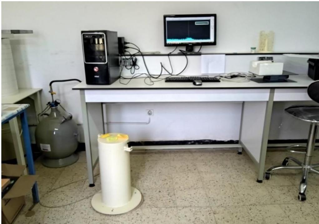
**Figure 25 : Chaîne spectrométrie Gamma utilisée**
