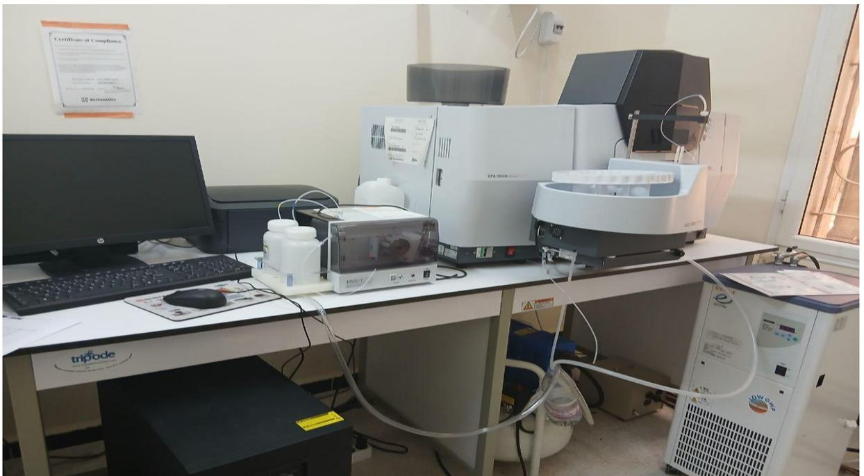
**Figure 13 : Equipment de la spectrométrie d'absorption atomique (SAA)**
