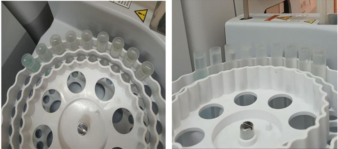
**Figure 20 : Remplissez les tubes et placez dans votre position pour l'analyse Analyse par Spectrométrie d'Absorption Atomique (SAA)**
