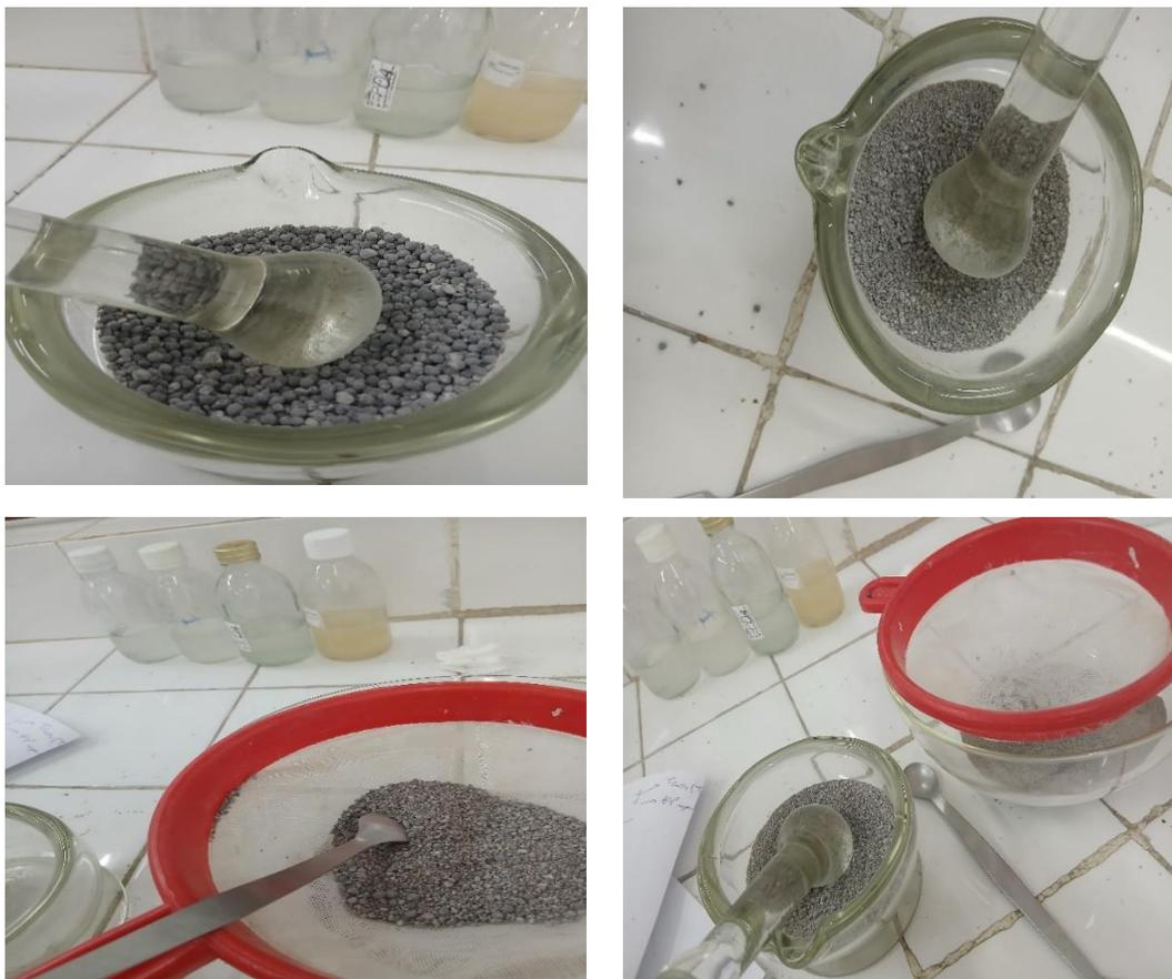
Figure 23: Broyage d'engrais
