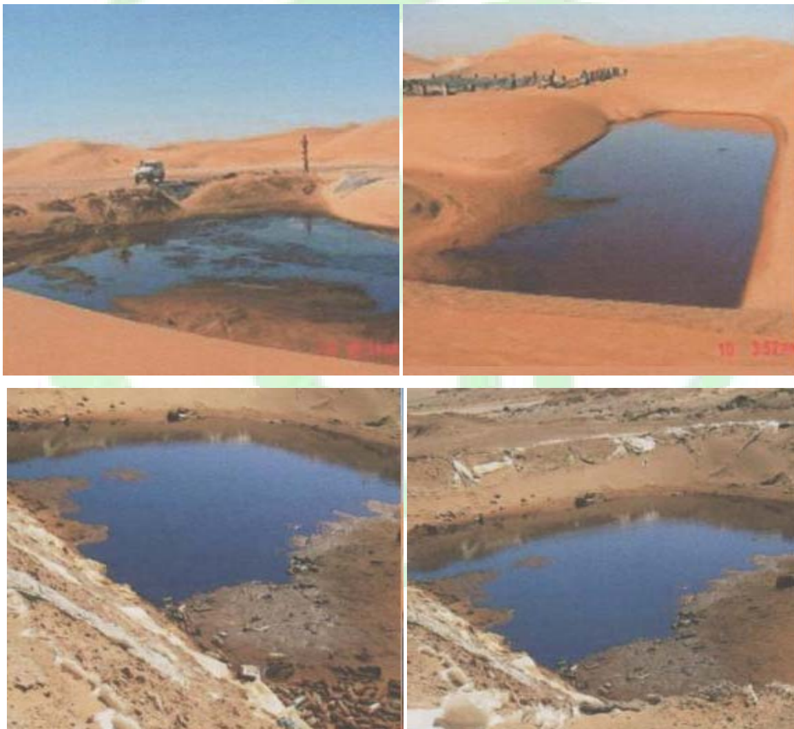
Figure I.2 : Bourbiers après une opération de forage
