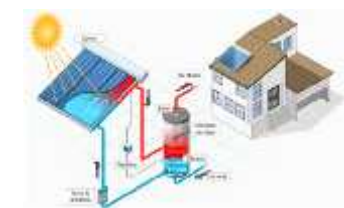
Figure 26 fonctionnement dun panneau solaire thermique source: https://www.les-energies-renouvelables.eu/conseils/chauffe-eau-solaire/panneau-solaire-thermique-chauffe-eau/
