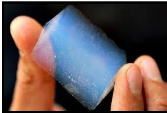
FIGURE 28 L'AEROGEL. SOURCE : [HTTPS://WWW.PRESSE-CITRON.NET/](https://www.presse-citron.net/)
