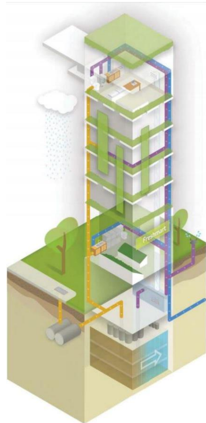
Figure 37 : Schéma de système d'irrigation Source : Centralparkwater.com
