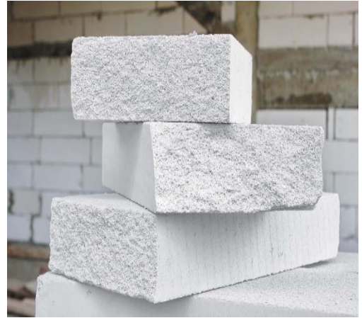
Figure 109 : le béton cellulaire, Source : futura-sciences.com
