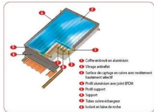
Figure 19 : Schéma de capteur plan thermique. Source : Uved université virtuelle environnement et développement durable.
