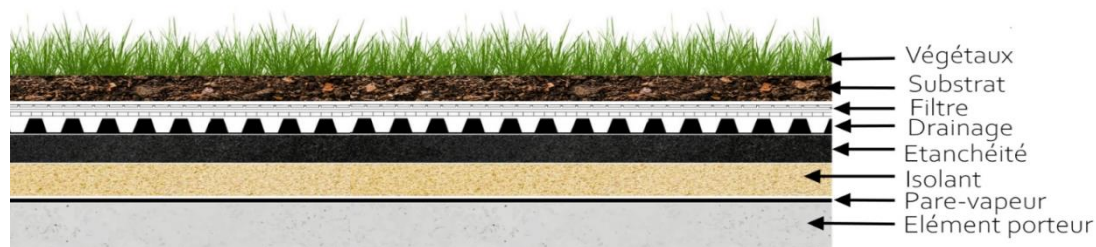
Figure 82 : Couches d'une toiture végétalisée, Source : Dsdrenov.
