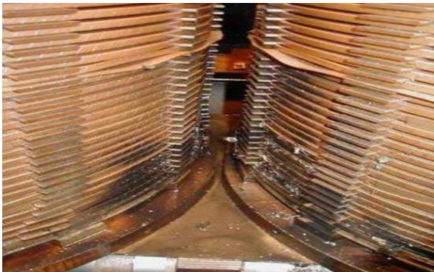
Figure I.9 Amorçage entre enroulements [10].
