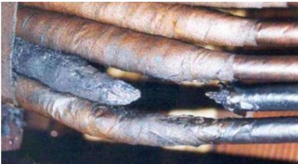
Figure I.13 Coupure suite à la fusion d'un Conducteur[11]
