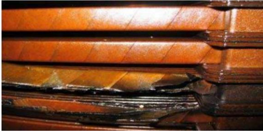
Figure I.10 Amorçage entre spires, sans court-circuit [11].
