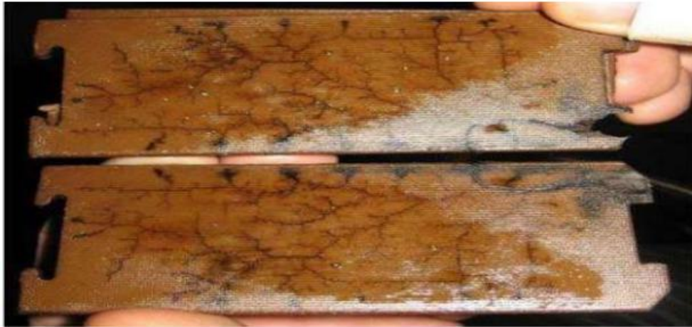
Figure I.12 Décharges partielles sur des cales [12].
