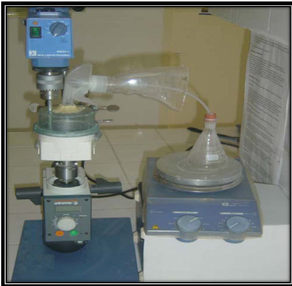
Figure II.3 : Schéma du mélangeur-granulateur conçu [2].
