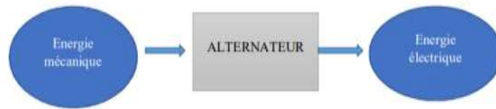
Figure I.12 : La conversion de l'énergie dans la génératrice
