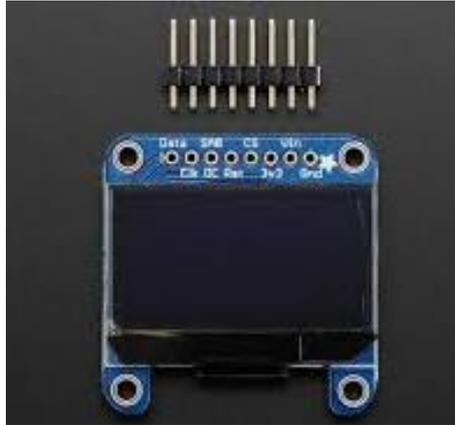
Figure II. 4 : Photo Écran OLED SH1106 1.3 pouces
