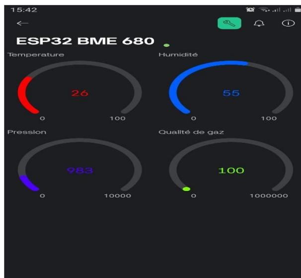
Figure III. 5 : Affichage des paramètres capteur BME680 sur Blynk
