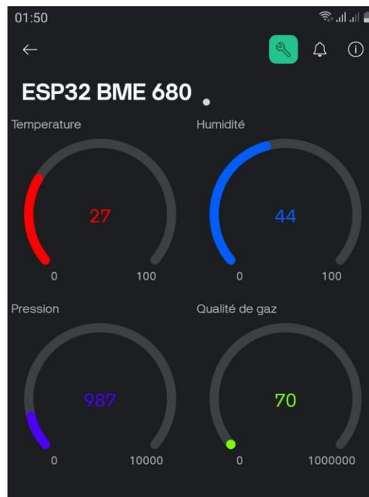
Figure III. 10: Visualisation en temps réel des paramètres via Blynk
