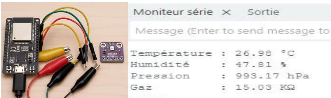
Figure III. 1 : montage du capteur BME680 et affichage sur moniteur serie
