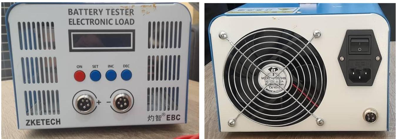
Figure 52 : testeur des batteries ZKE Tech version EBC
