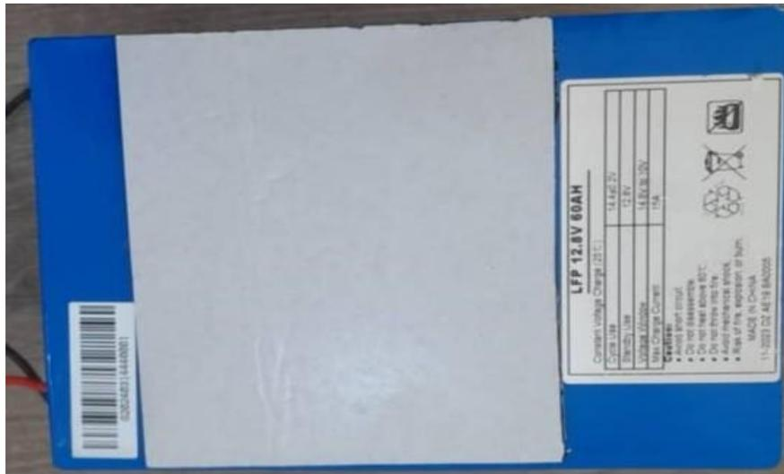
Figure 33: Batterie extraite d'un luminaire solaire → Vue réelle de la batterie après démontage du boîtier du luminaire
