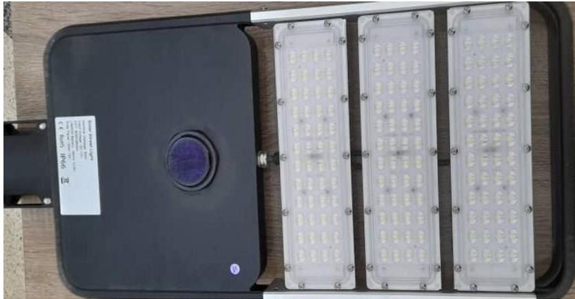
Figure 34: un luminaire solaire montrant les LED de type SMD → Focus sur le système d'éclairage intégré au luminaire.
