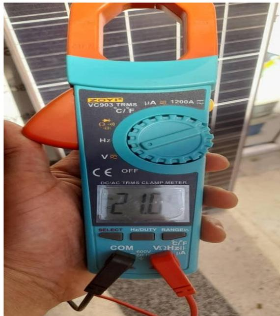
Figure 44: mesurée la Tension ( $V_{oc}$ ) des panneaux solaires avec un multimètre.
