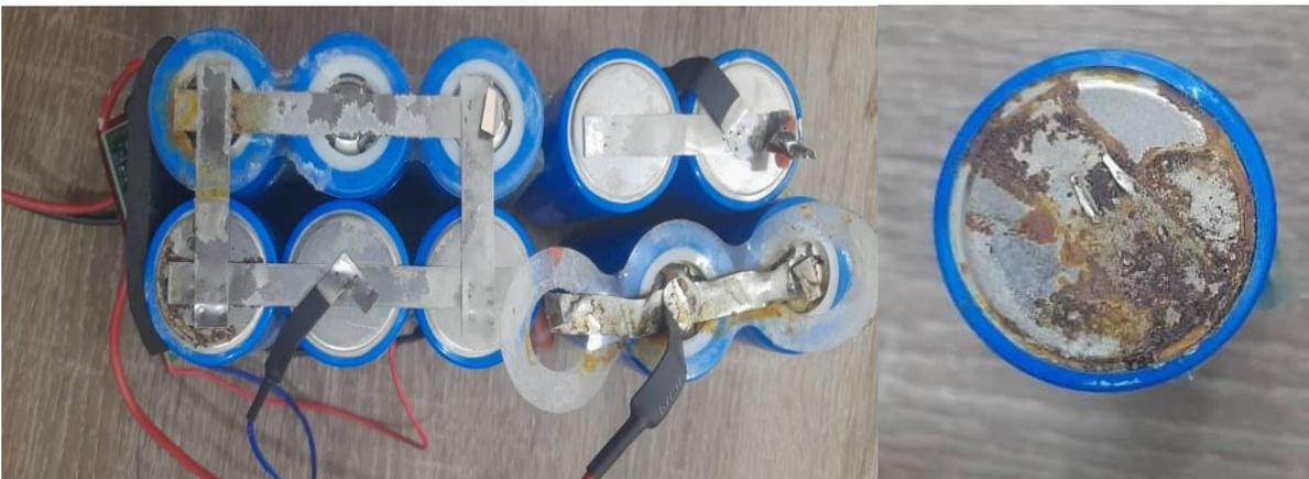
*Figure 51: la corrosion que nous avons trouvée sur la batterie.*
