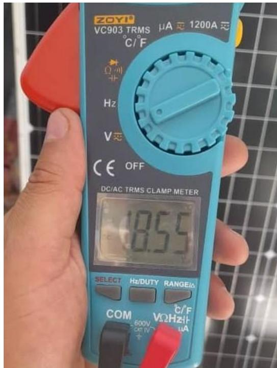
Figure 41: Mesurer la tension ( $V_{oc}$ ) des panneaux solaires avec un multimètre.
