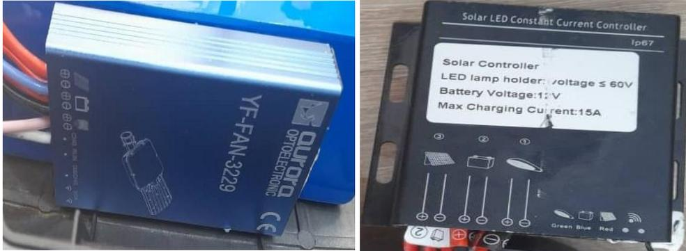
Figure 32: Deux régulateurs de charge extraits de luminaires différents → Chaque régulateur provient d'un système solaire distinct (All-in-One et All-in-Two)
