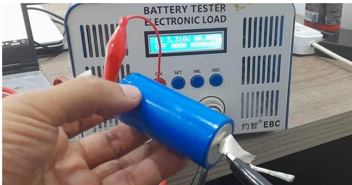
*Figure 49: tester une seule cellule de batterie avec ZKE Tech EBC.*
