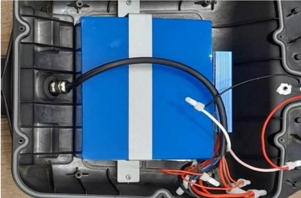
*Figure 40: 1re étape : démonter le luminaire solaire.*
