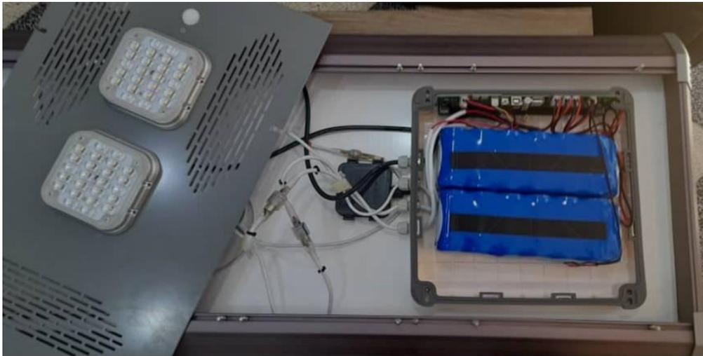
Figure 45: démonter le luminaire solaire
