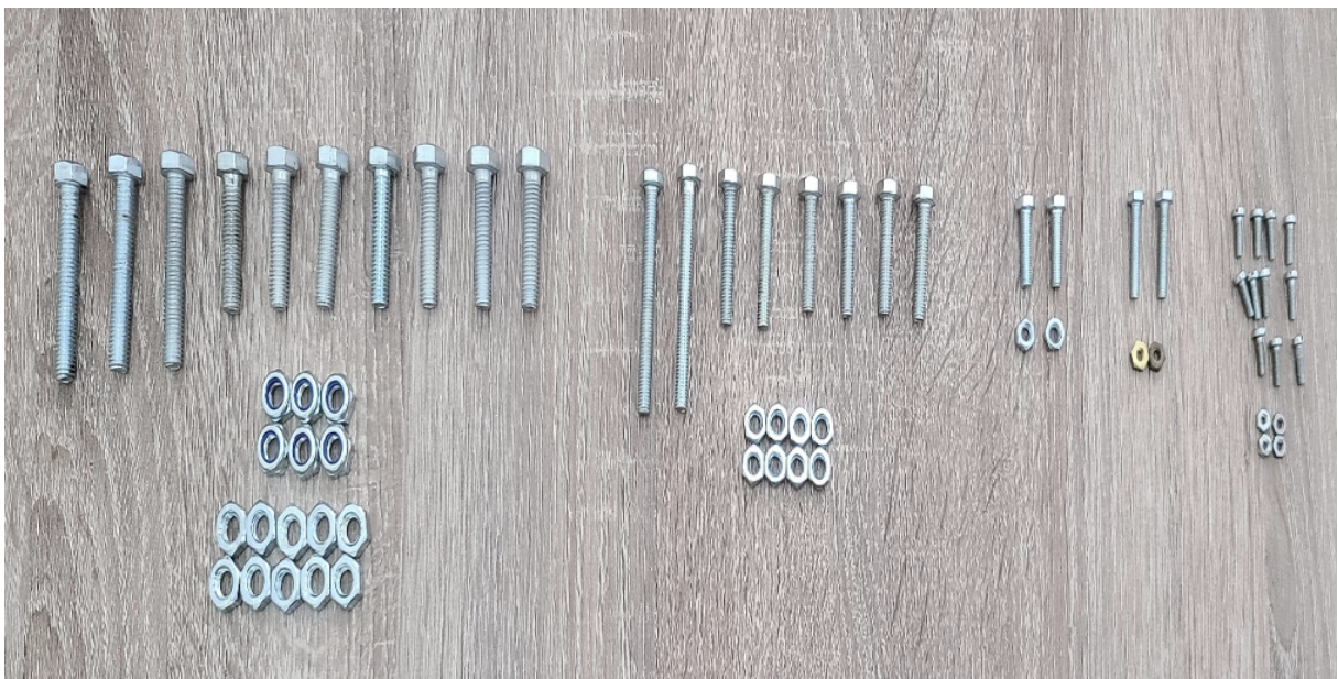
Figure 4.9: les boulons et les écrous utilisés
