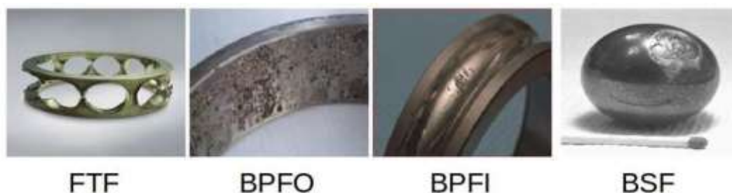
Figure II. 11: Montre les éléments cruciaux d'un roulement à billes [41] .
