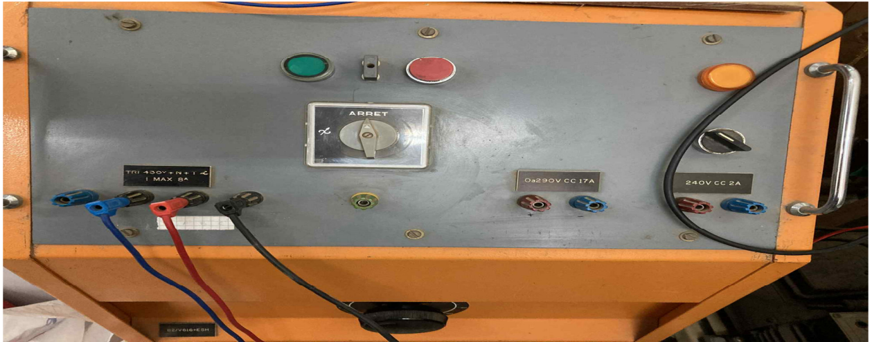
Figure 4.2 : Tension d'alimentation triphasée.
