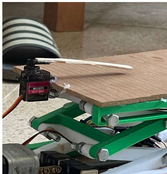
Figure 2.12 Fixation du moteur servo SG90 dans la nacelle du robot
