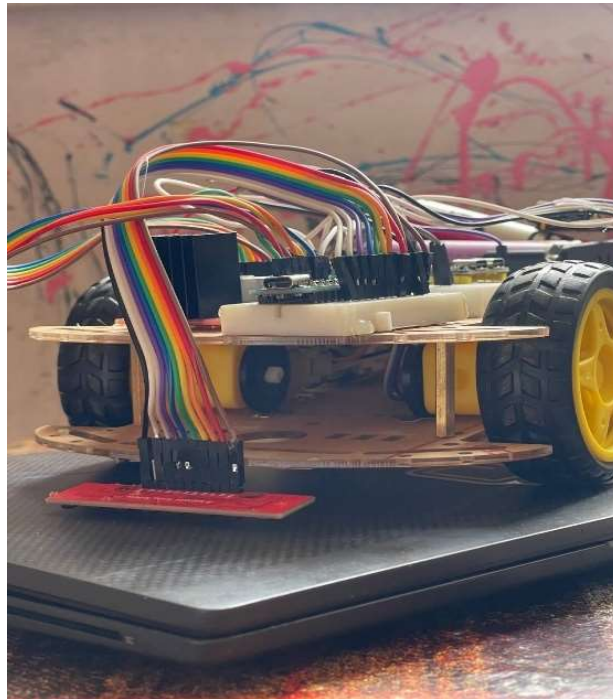
Figure 2.5 Fixation du QTR-8A sur le Châssis du Robot
