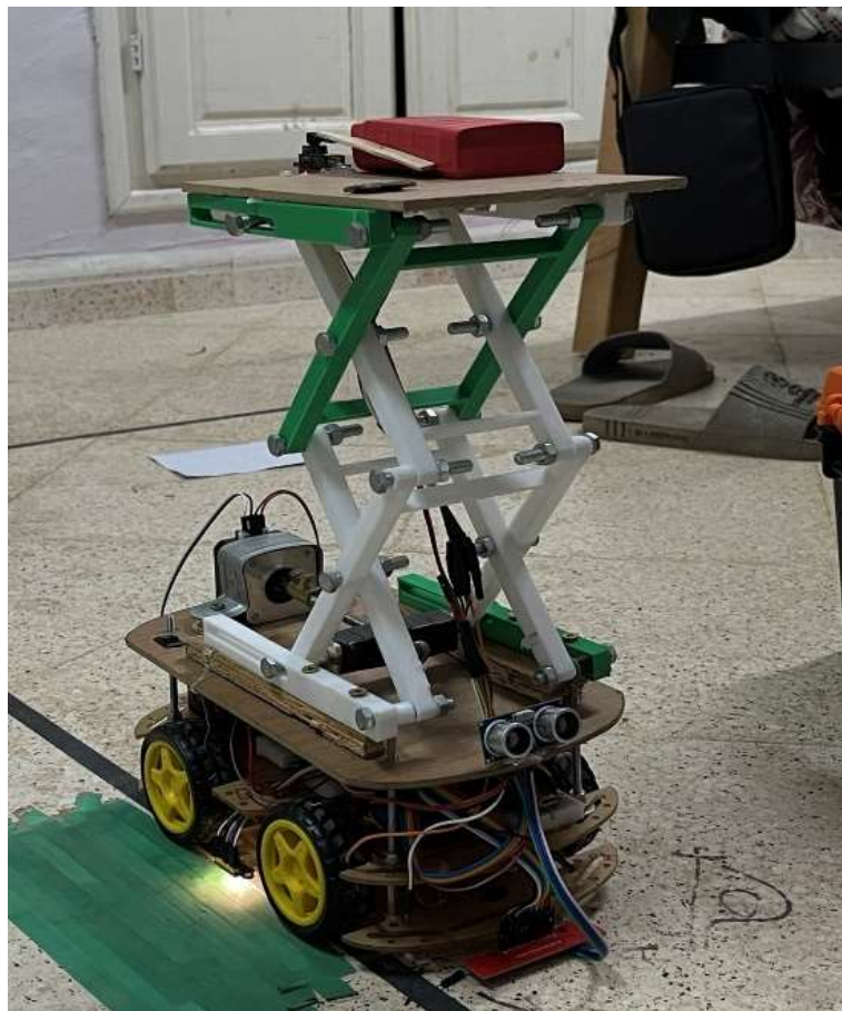
Figure 3.9 Séquence de levage et de dépose d'un objet par le robot
