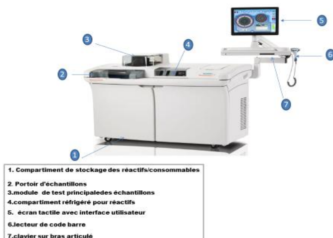
Figure 4 : l'analyseur d'immunoessais Siemens Healthineers IMMULITE 2000 Xpi utilise pour le dosage des IgE (IMMULITE® 2000 XPi.)
