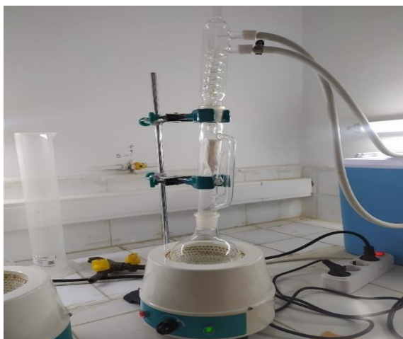
Figure 21: Chauffage à reflux
