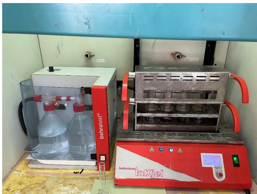
Figure 23: Appareils de dissolution rapide à infrarouge pour la détermination d'azote selon Kjeldahl (Behrotest InKjel)
