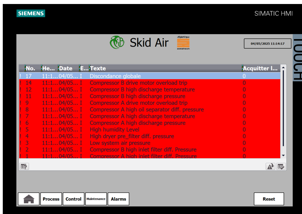
Figure III-31 : Vue des alarmes de système
