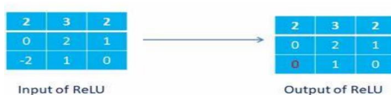
Figure 2.4 Exemple de la formule \text{ReLU}(x) = \max(0, x) [27].
