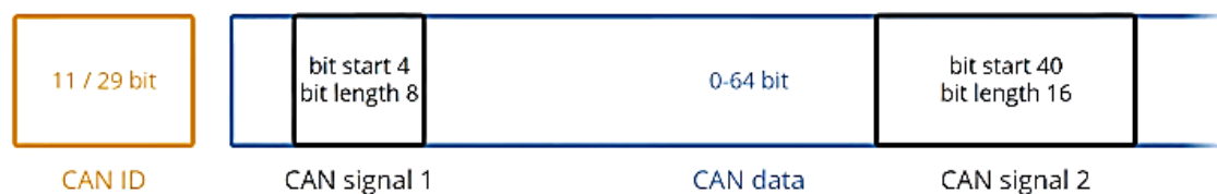
Figure 2.13 : Exemple d'une trame CAN contenant deux signaux avec un seul CAN-ID. [33]
