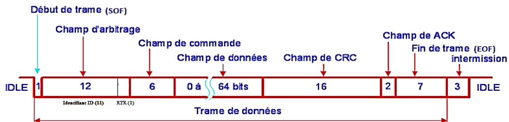
Figure 2.10 : Constitution des champs d'une trame de donnée du protocole CAN. [26]
